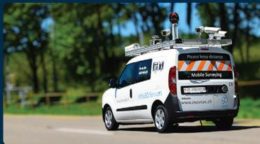
Erfassung der Straßenräume mit infra3D-Technologie und Generierung des intelligenten digitalen 3D-Abbildes der Straßen als perfekte Grundlage für die bildbasierte Zustandsanalyse.
