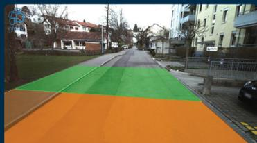
KI-basierte Erkennung und Klassifizierung von Schäden der Fahrbahn-oberfläche in den infra3D-Strassenbildern. Bildung und Klassifizierung von homogenen Zustandsabschnitten.
