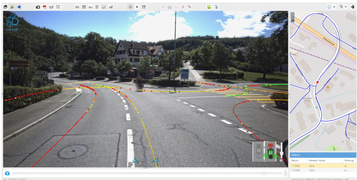
Strassenzustandsanalyse mittels infra3D Service
