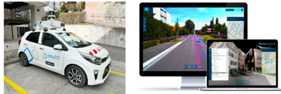
Messfahrzeug der iNovitas AG und infra3D Software. Panoramabilder und Punktwolkenpanorama.
